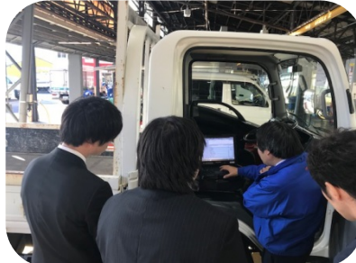
パソコンを使った車両の故障診断を実演
